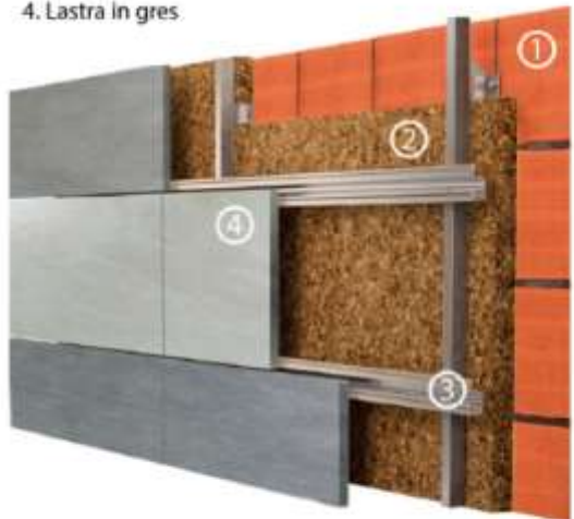
1. Stratigrafia di una parete ventilata A ventilated façade: stratigraphy
